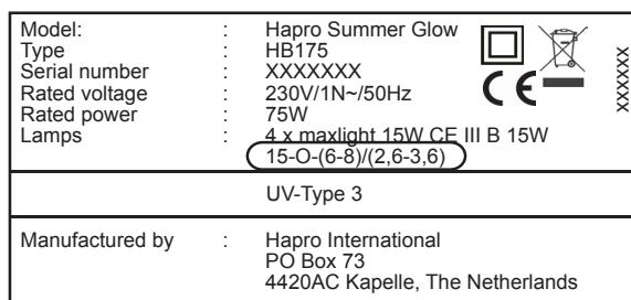
Si vous projetez d'installer une nouvelle lampe, la puissance et le type de réflecteur doivent toujours correspondre au code équivalent sur la plaque d'identification. L'érythème effectif et le rapport NMSC doivent également correspondre à la gamme spécifiée.
